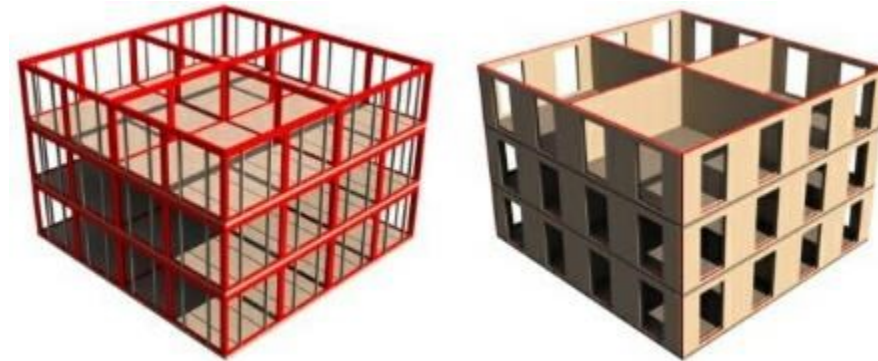
Telaio strutturale in legno lamellare con tamponamenti in pannelli di legno multistrato
